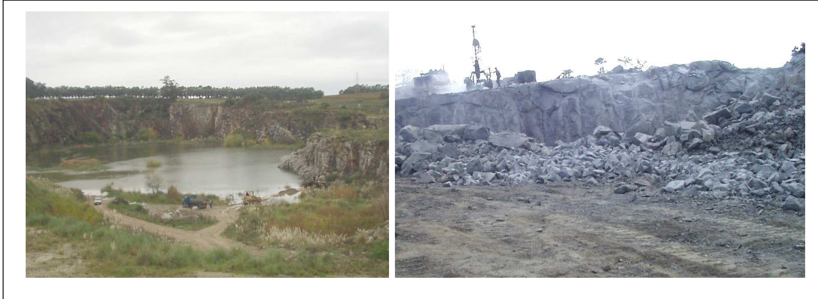
Figura 18 : La imagen de la izquierda corresponde a una vista panorámica de la cantera de piedra partida de AFE, en Joaquín Suárez. La foto de la derecha corresponde a una cantera en la zona del A° Cueva del Tigre explotado por la empresa Colier. Sobre el banco se observa una perforadora, realizando los barrenos para la voladura. Al pie del banco se observa una gran cantidad de bloques de diferente tamaño producto de una voladura anterior.
