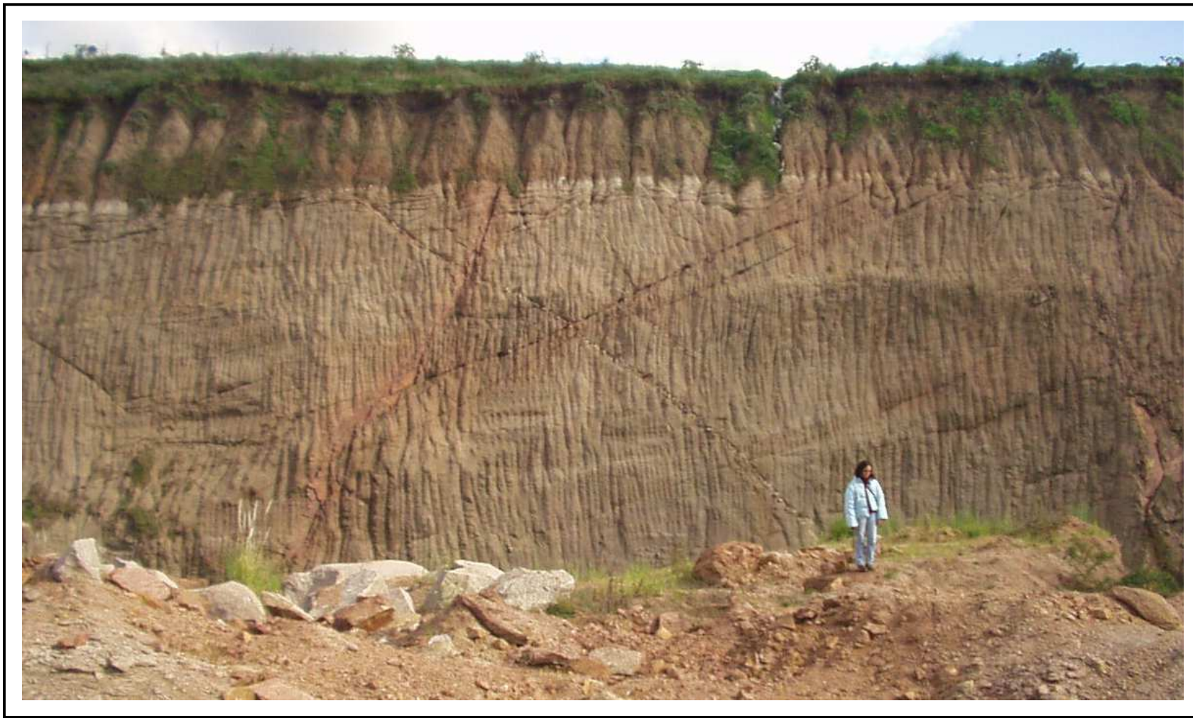
Figura 6 : Perfil característico de una cantera de balasto donde se observa en la parte superior una capa más oscura, que corresponde con la cobertura estéril representada por suelo y sedimentos limo-arcillosos (Formación Libertad) y una capa inferior marrón clara, que se corresponde con el Granito de La Paz alterado y sumamente fracturado, que es el material comercializado como balasto o pedregullo en el caso de ser procesado..
