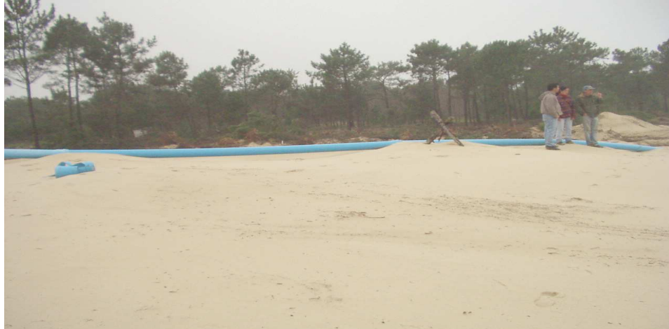
Figura 35 : Se muestra un acopio de arena de la misma cantera mostrada en la figura anterior , que corresponde a la “pileta” llena formada por el método extractivo de dragado-refulado
