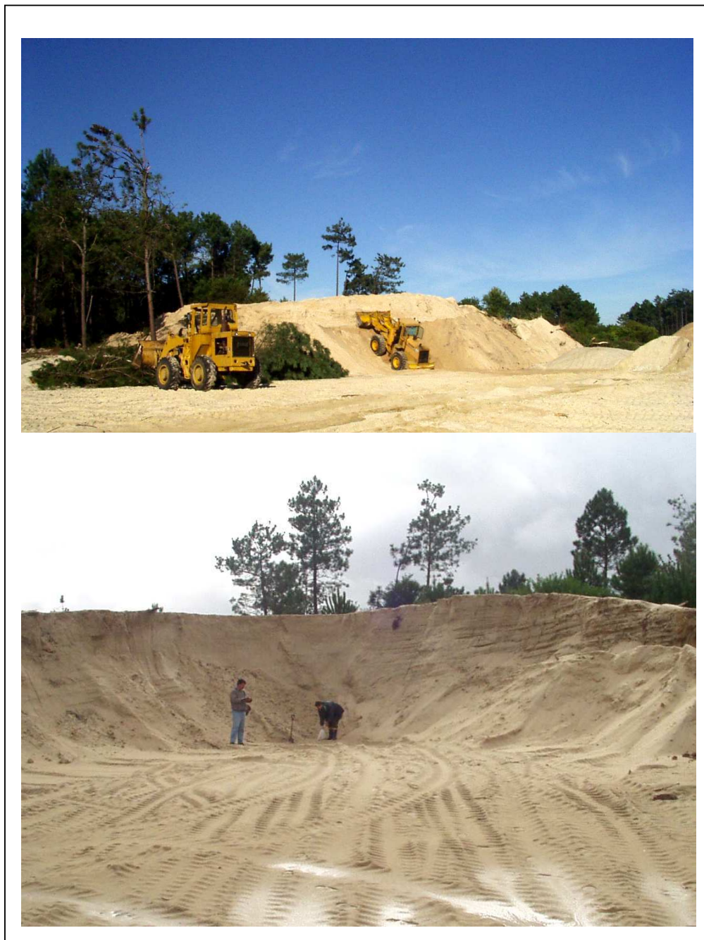
Figura 43 : En la imagen superior se muestra la limpieza y preparación de un gran médano para ser explotado, en la zona de El Pinar norte. En la foto inferior otro médano más pequeño, en etapa de explotación, en la zona de Salinas norte. En ambos casos la extracción se realiza con pala frontal y el límite máximo vertical que están autorizados es un poco por encima del nivel de calle.
