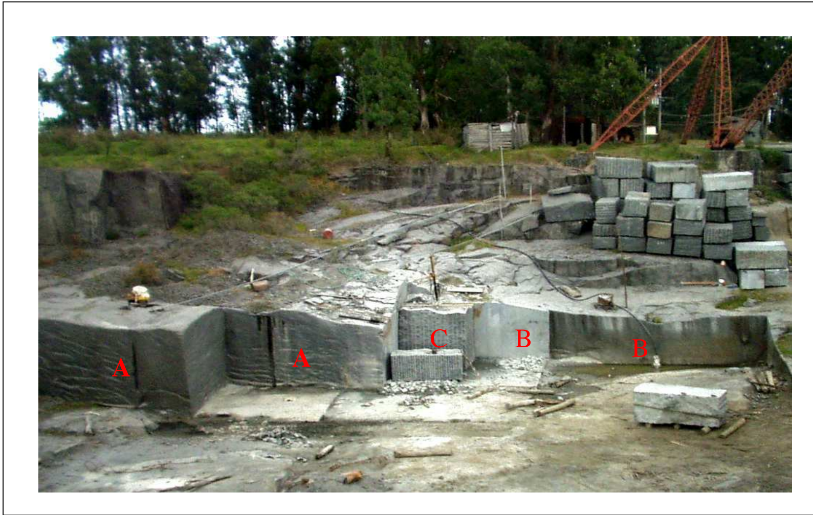
Figura 49 : Detalle de una parte del banco de la cantera de “Froche”. Obsérvese las diferentes texturas de los planos tanto en los frentes como en los bloques, como en el piso, provocadas por el empleo de tres diferentes métodos de corte. A la izquierda de la imagen (letra A) la superficie es irregular con figuras curvas producto del empleo del “jet flame”. A la derecha y parte del piso (letra B) la superficie de corte es lisa, producto del corte con hilo diamantado. Y en el centro (letra C) las superficies son acanaladas, por el uso de martillos.
