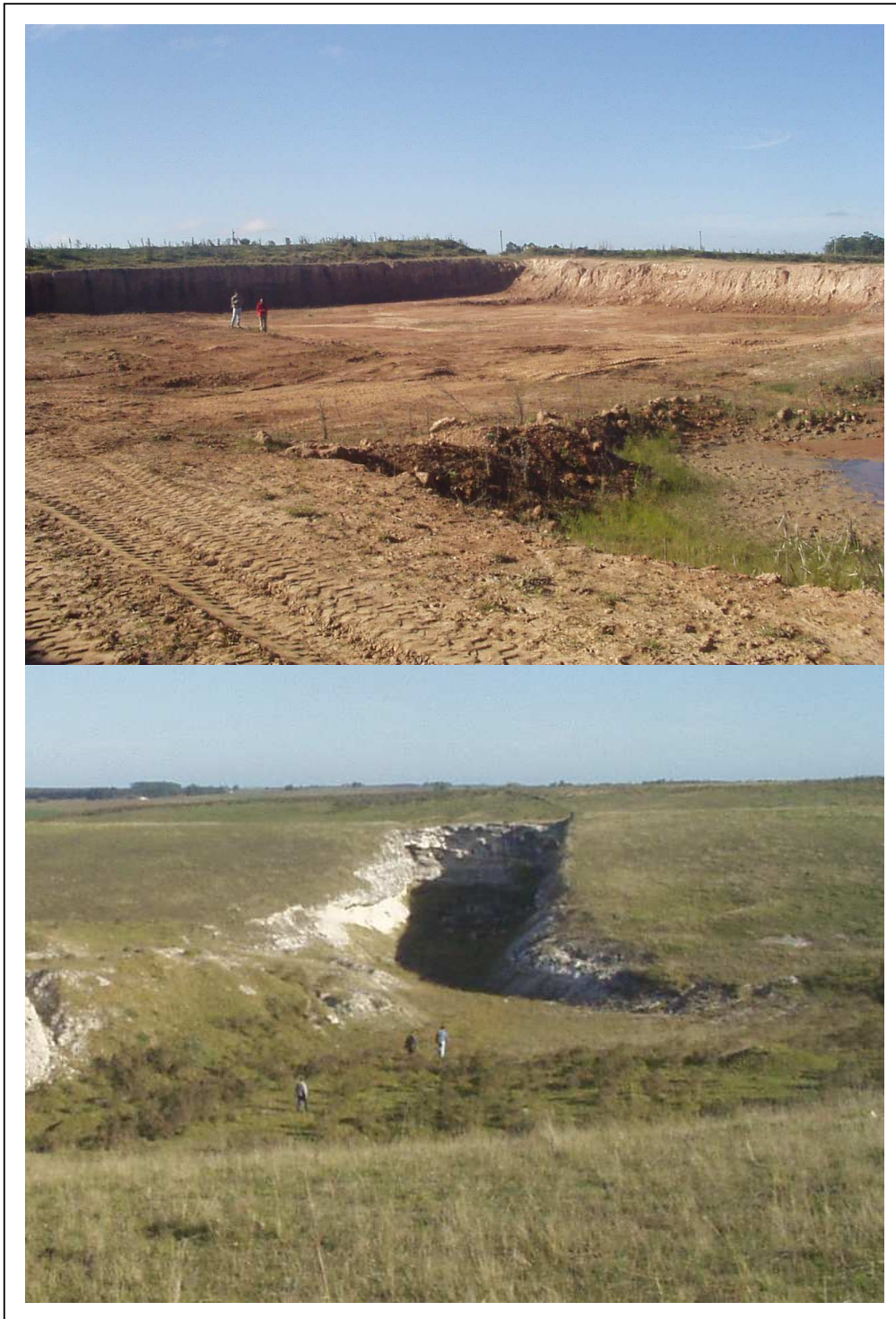
Figura 54 : Foto superior 54-A cantera de Marga en la zona norte de la localidad de San Antonio, explotada por la empresa Metzen y Sena. En la foto inferior 54- B se observa uno de los varios “socavones” abiertos en material calcáreo-arenoso (calcretas)” para la explotación de piedra caliza, en la zona de Sauce Solo.
