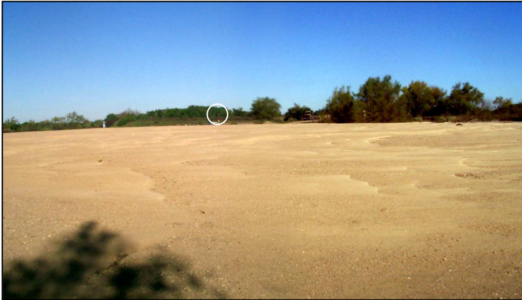
Figura 22 : Extracción de arena en una barra del Arroyo Vejiga. Dentro del círculo blanco se observa a una persona , que marca aproximadamente la posición del frente de “ataque” del cuerpo arenoso (ver figura siguiente) . Obsérvese además la enorme extensión del depósito.
