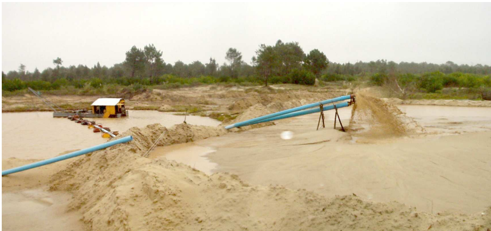
Figura 34 : Cantera de arena donde se utiliza para la extracción el método de dragado. Al fondo de la imagen se observa la balsa instalada sobre la zona de succión. A través de la tubería azul, se traslada la arena + agua desde el lecho del lago artificial hacia la zona de acopio. Aquí el material es volcado en una “pileta” donde decanta la arena y se va por gradiente el agua y material fino.
