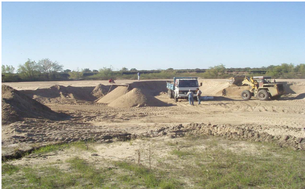
Figura 23 : Foto de la misma barra arenosa de la figura anterior, pero tomada desde el otro extremo. La extracción se realiza con pala frontal articulada, hacia un camión. El frente es de aproximadamente 2 m. de potencia, aunque la arena continúa en profundidad. Obsérvese en el fondo de la imagen una “franja” oscura, que se corresponde con la barranca de abrasión del arroyo.
