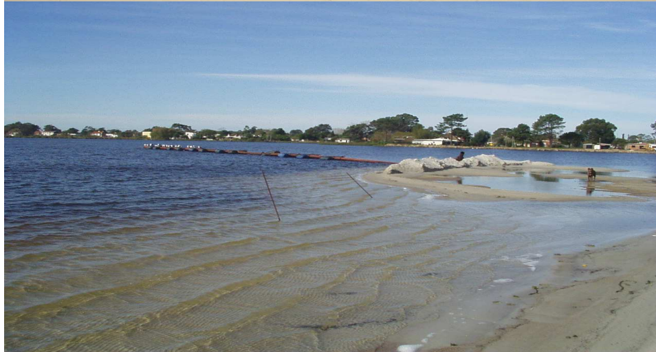
Figura 36 : Otra antera de arena que también utiliza el método de dragado, donde se ve en el centro- derecha de la imagen una “pileta” en formación y la tubería por donde se alimenta a la misma. Esta labor minera está localizada en la zona de Carrasco. Obsérvese la magnitud del lago generado a través de décadas de explotación.
