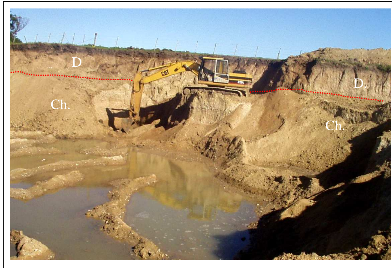
Figura 27 : Cantera de arena ubicada en la terraza alta del arroyo Solís Grande, cerca de su desembocadura. El método de arranque es con retroexcavadora hacia un camión, el cual lleva el material a la planta de lavado/clasificación. Se separa aproximadamente con una línea roja un nivel inferior (Ch. = Formación Chuy ?) que representa el material explotado y por encima se ubica la cobertura (D = Formación Dolores ? + suelo) que solo puede ser comercializada como material de relleno. La profundidad máxima de explotación esta marcada aproximadamente por el extremo de la cuchara.
