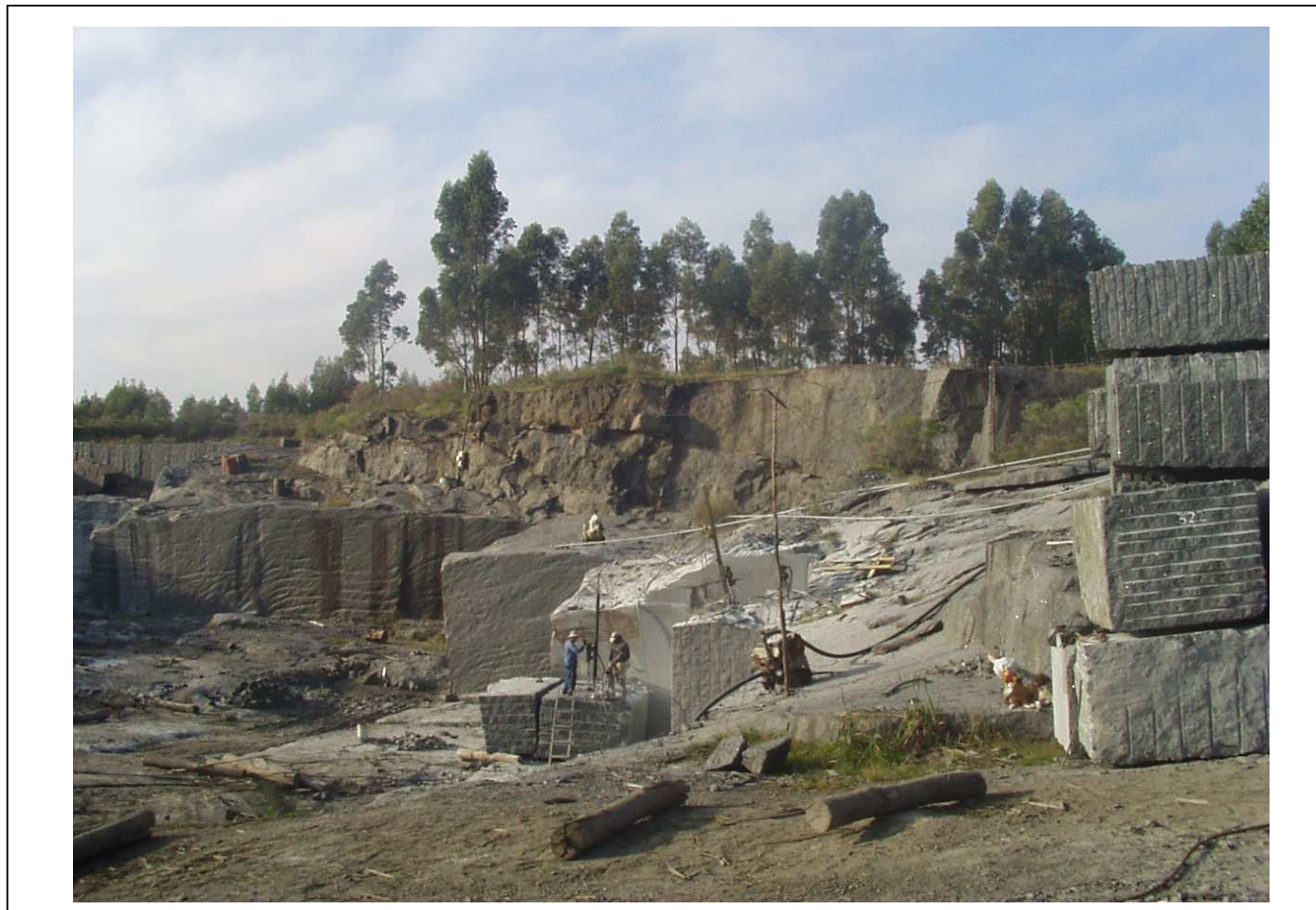
Figura 48 : Cantera de roca ornamental en el Granito de Soca. Obsérvese la presencia de dos frentes. La zona superior de color oscuro muy alterado, es retirado como escombrera , además se ve una importante fractura curva-horizontal. El inferior de color gris es el banco de “corte” de donde se extraen los bloques que aparecen a la derecha de la imagen. En el primer plano se ve además dos operarios cortando un bloque mayor con martillo neumático.
