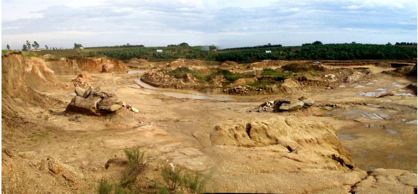
Figura 16 : Cantera de Tosca en la zona de Empalme Olmos, donde se observan zonas sin explotar más resistentes, formadas en muchos casos por litologías pegmatoides.
