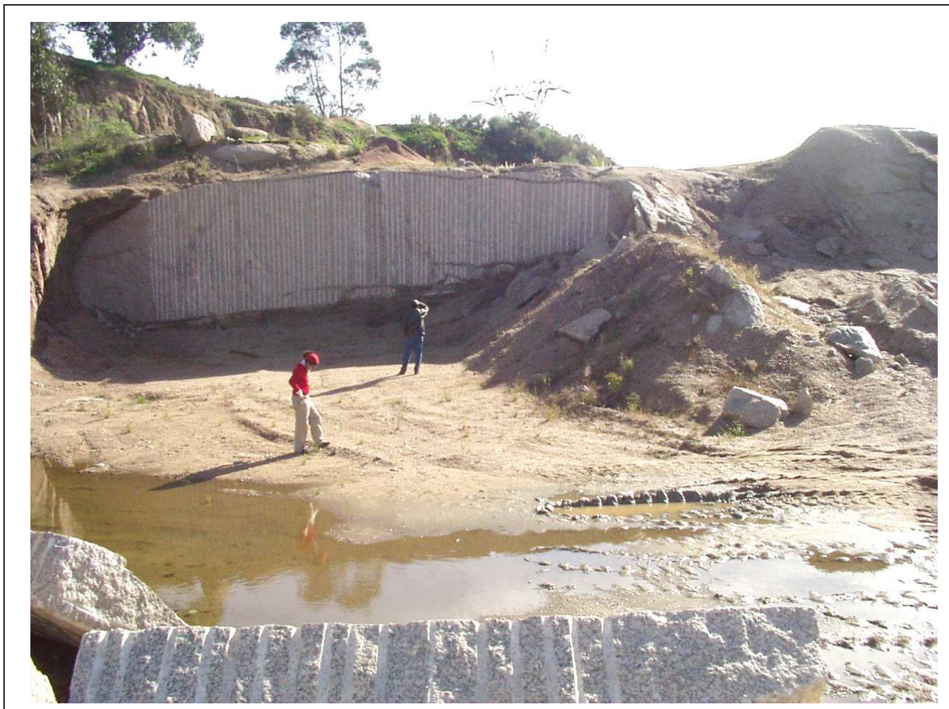
Figura 51 : Enorme bocha de granito rosado, porfiroide de la Zona de La Paz, denominado comercialmente como Caramel Pink. En primer plano un bloque con la cara acanalada producto del sistema de arranque y corte utilizado.
