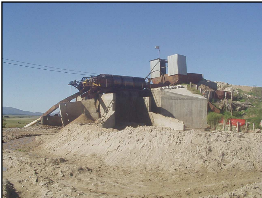
Figura 28 : Planta de procesamiento del material en “bruto”. El mismo se vuelca en la parte superior y se introduce a la zaranda cilíndrica giratoria con abundante agua. Básicamente se separan 4 fracciones granulométricas : arena fina, arena gruesa, canto rodado fino (pedregullo) y canto rodado grueso (bloques).
